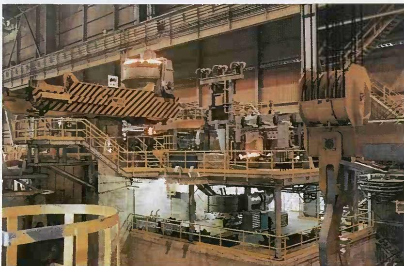
*Die Strangiessanlage des modernen Elektrostahlwerkes*
