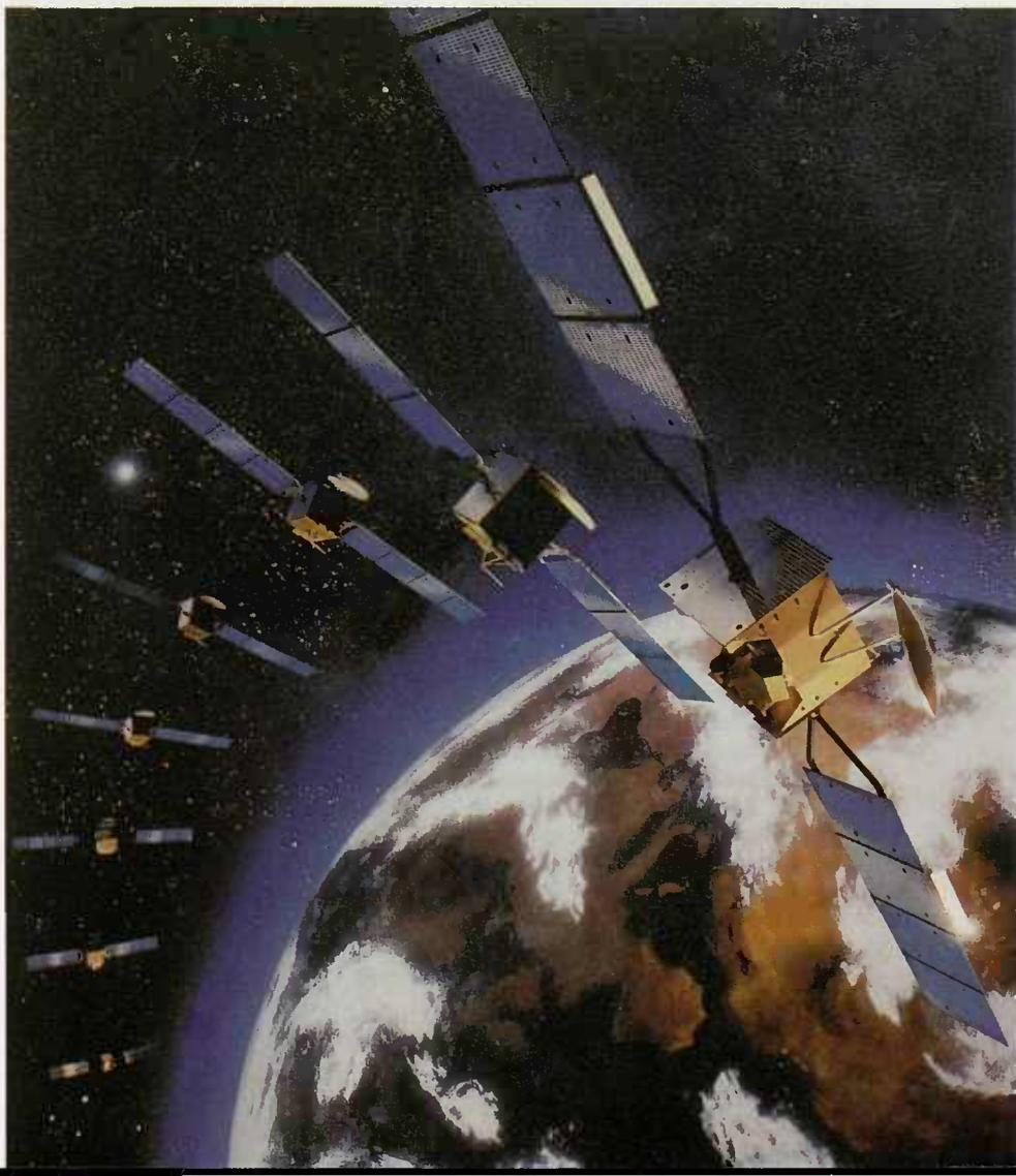
gallium arsenide, générant une puissance de 8 kW, ce qui permettra une nouvelle optimisation de la zone de couverture d'ASTRA.
