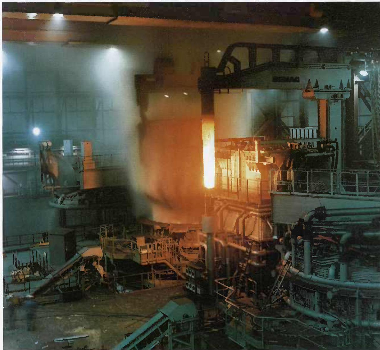
Les nouvelles installations de ProfilARBED Differdange: le four électrique
